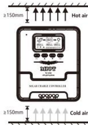
Fig. 2.1 Instalación y disipación del calor
